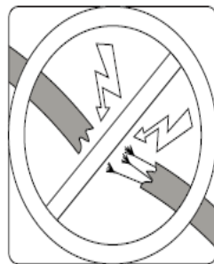
Перевірити цілісність кабелів
